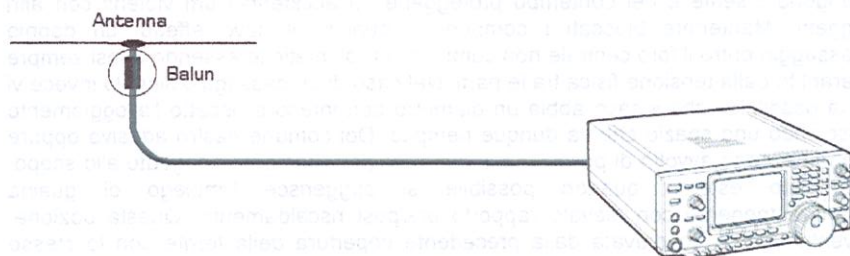
Figura 16. Posizione delle ferriti per realizzare un Balun
